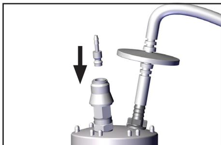
Nur BVC mit Schnellkupplung für Anschluss VacuuHand-Control VHC<sup>pro</sup>
