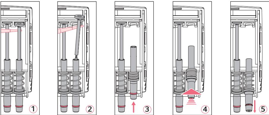
1. ① und ②: Eine Pipettenspitze unter dem Kolben ansetzen und den Kolben vorsichtig aus der oberen Schiene lösen.
