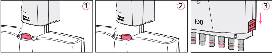
1. ① und ②: Den Hebel am Unterteil nach links oder rechts schieben. Das Unterteil nach unten ziehen, um die magnetische Kopplung des Unterteils am Oberteil aufzuheben. Das Unterteil wird dabei vom Oberteil getrennt und kann abgenommen werden.
