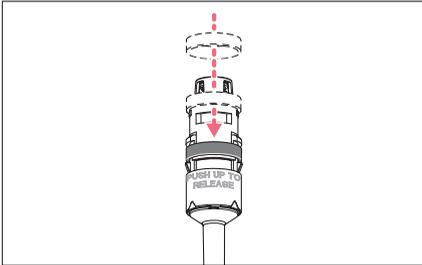
1. Den schwarzen Sperrring von oben auf das Unterteil schieben. Dabei die Klammern am Unterteil leicht zusammendrücken.
