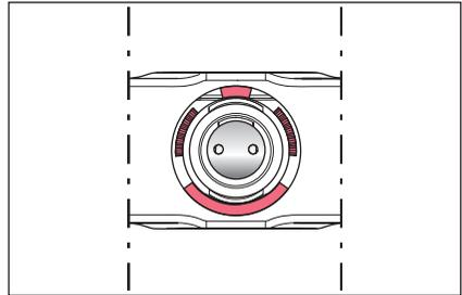
3. Sehen Sie Sich das gelöste Unterteil von oben an. Schieben Sie dazu die Gehäuseschale nach unten. Prägen Sie sich genau die Position der rot gekennzeichneten Teile ein. **Die rot gekennzeichneten Anschläge auf der Gehäuseschale und die rot gekennzeichneten Zähne am Innenteil sind benachbart.** Sollten nach Zusammenbau Anschläge und Zähne aufeinander liegen, ist die Gehäuseschale falsch aufgesetzt worden.
