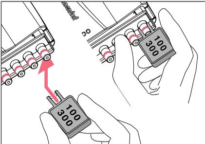
1. Das O-Ringwerkzeug (Lieferumfang) mit der Öffnung seitwärts an den Spitzenkonus drücken, dass die scharfe Kante in der Öffnung des O-Ringwerkzeugs mit dem O-Ring übereinander liegt. Das O-Ringwerkzeug nicht auf den Konus schieben! Die Abbildung zeigt das O-Ringwerkzeug für 100  $\mu$ L und 300  $\mu$ L. 1 200  $\mu$ L hat ein eigenes O-Ringwerkzeug.
