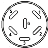
Abb. 24: Pinbelegung der DIN-Buchse (10) für Option Analogausgang
