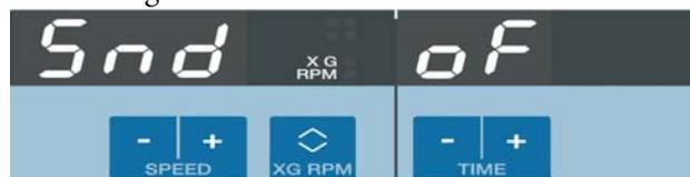
4. Drücken Sie die Taste
