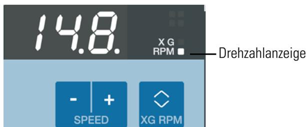
2. Wenn neben der Anzeige das obere Feld leuchtet wird der RZB-Wert angezeigt. Drücken Sie die Taste
