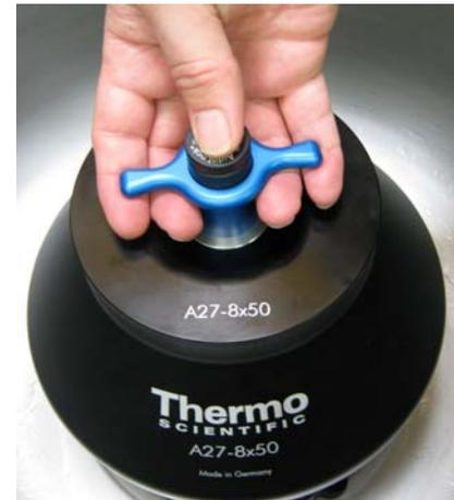
Abbildung 6. Position der Hände beim Rotorausbau
